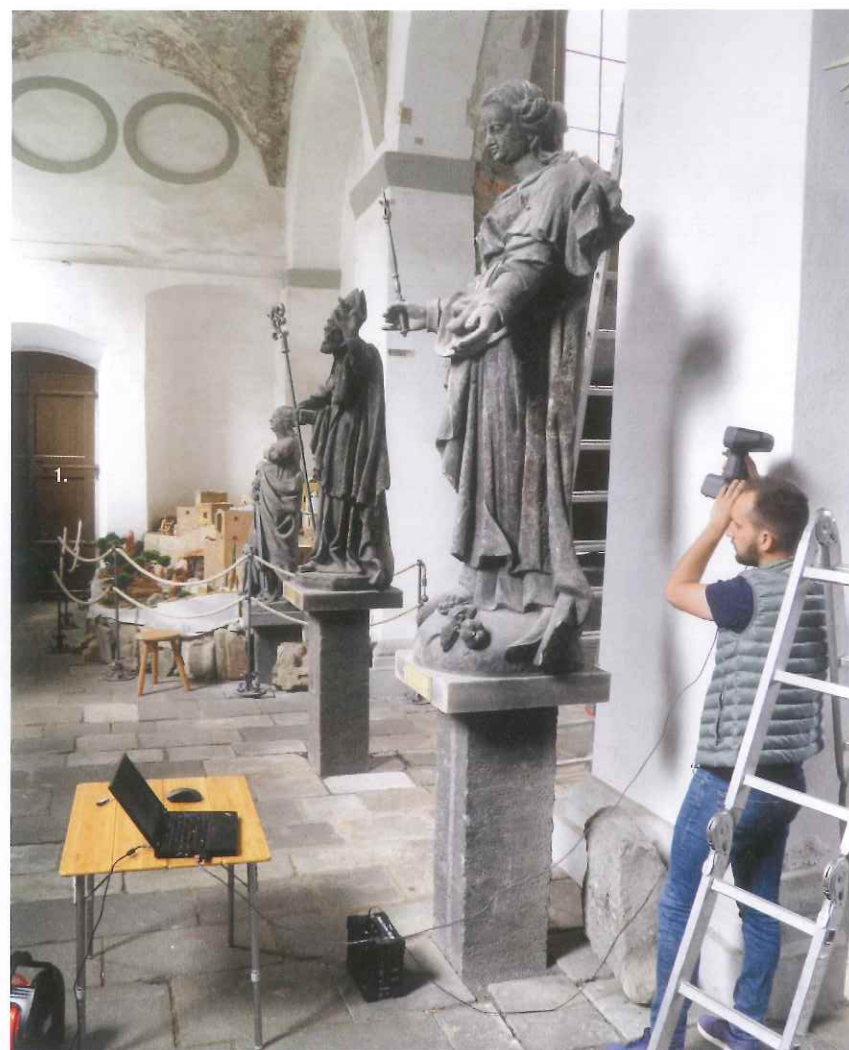
Die Heiligenfiguren werden mit einer speziellen 3-D-Kamera aus allen Winkeln gescannt, damit die Steinfräse später alle detaillierten Informationen erhält, die sie für ihre Arbeit benötigt
