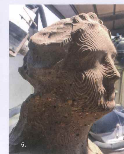
1. Um Zeit zu sparen, wird die Kontur mit einer Konturenseilsäge aus dem Steinblock geschnitten. 2. Der Roboter übernimmt, erste Feinheiten werden sichtbar. 3. Mit einer speziellen Software werden Größe und Art der Fräser an den Roboter übermittelt. 4. Fräsarbeiten im Nassen, um Staub zu binden und Werkzeug zu kühlen. 5. Ausgefäster Kopf der HI. Margaretha
