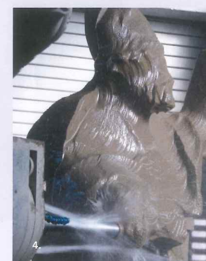
1. Um Zeit zu sparen, wird die Kontur mit einer Konturenseilsäge aus dem Steinblock geschnitten. 2. Der Roboter übernimmt, erste Feinheiten werden sichtbar. 3. Mit einer speziellen Software werden Größe und Art der Fräser an den Roboter übermittelt. 4. Fräsarbeiten im Nassen, um Staub zu binden und Werkzeug zu kühlen. 5. Ausgefäster Kopf der HI. Margaretha
