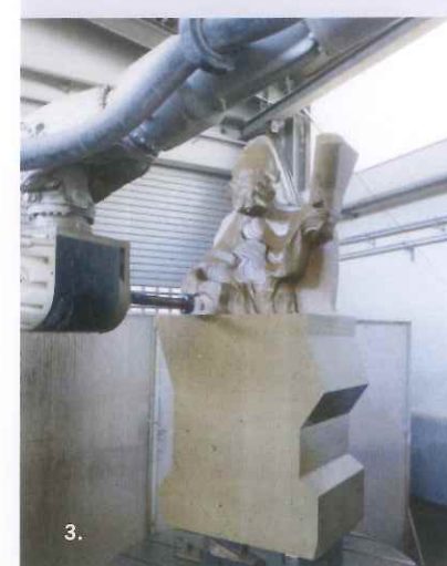
1. Um Zeit zu sparen, wird die Kontur mit einer Konturenseilsäge aus dem Steinblock geschnitten. 2. Der Roboter übernimmt, erste Feinheiten werden sichtbar. 3. Mit einer speziellen Software werden Größe und Art der Fräser an den Roboter übermittelt. 4. Fräsarbeiten im Nassen, um Staub zu binden und Werkzeug zu kühlen. 5. Ausgefäster Kopf der HI. Margaretha
